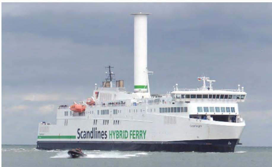
> Desde mayo de 2020, el ferry “Copenhague” de la naviera Scandlines utiliza rotores Flettner de la firma Norsepower. Cada rotor mide 30 metros de altura, 5 metros de diámetro y pesa 42 toneladas.
