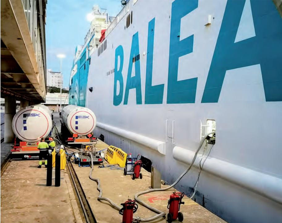
> Una imagen ya común en los puertos utilizados por la naviera Baleària. Recarga de GNL en el puerto de Almería a un ferry de la naviera.
