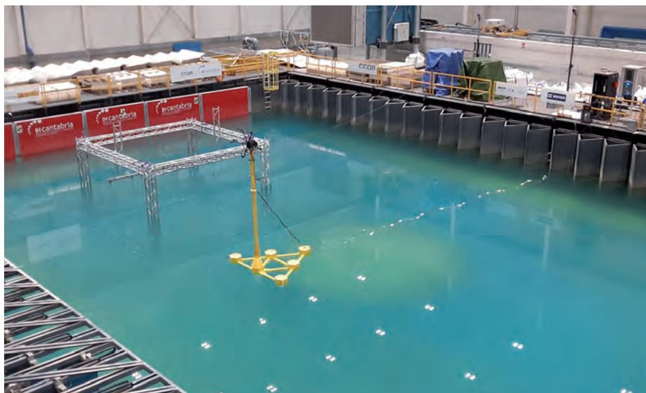
➤ Ensayos con modelos del Hivewind en el canal de experimentación del IHCantabria.
