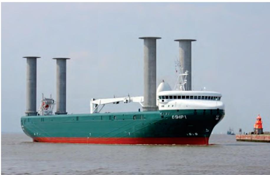
> El Ro-ro “E Ship1” fue construido y entregado en 2010 por los astilleros Lindenau (Kiel - Alemania) a su armador, el constructor de turbinas eólicas Enercon GmbH. Emplea cuatro rotores de 27 metros de altura y 4 de diámetro para ayudar a la propulsión generada por 9 motores - generadores Caterpillar. Los cilindros giran a más de 300 r.p.m. dependiendo de la velocidad del viento y el rumbo del buque.
