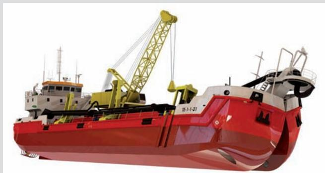
➤ Imagen virtual de una de las dragas de casco partido diseñadas y construidas por los astilleros Nodosa en Marín, en el proceso de abrir la cántara.
