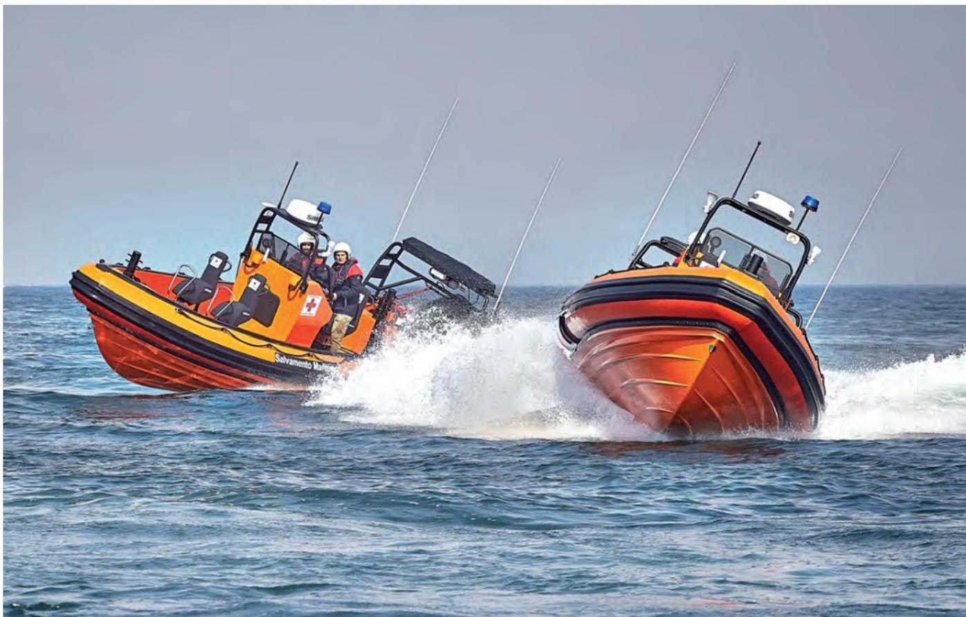
> Semirrígidas Vanguard TX-750D fabricadas a medida para Salvamento Marítimo. La doble motorización ofrece 350 CV y autonomía extendida. (Foto cortesía de Vanguard Marine.)
