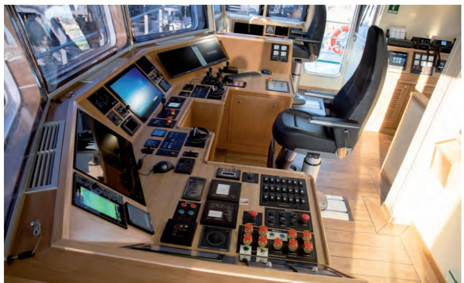
➤ Puente del buque con los sistemas de control de navegación y dragado.
