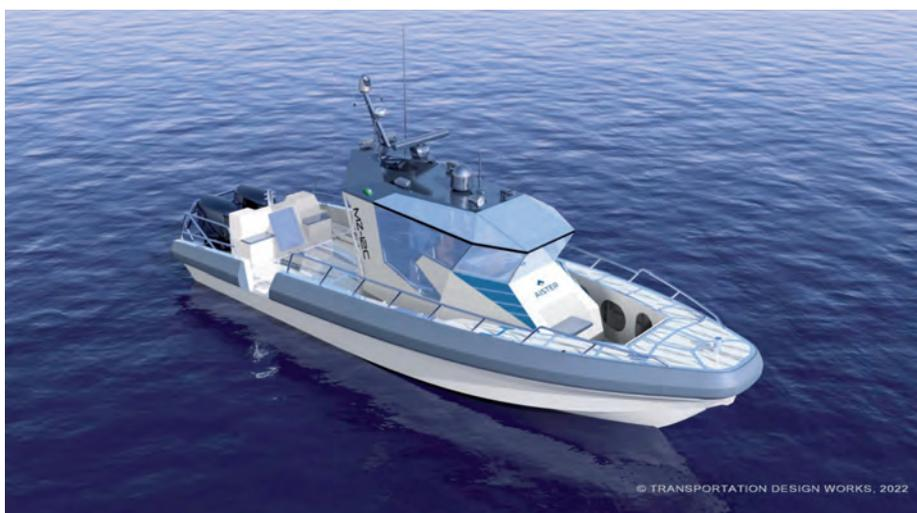
> Con un diseño de 11,38 metros de eslora y dos motores fueraborda de 350 HP cada uno, las patrulleras MZ12 podrán alcanzar velocidades punta de más de 40 nudos.
