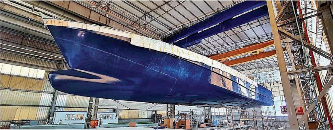
> Estructura en PRFV del casco de la patrullera a su salida del molde en las instalaciones de Rodman en Moaña.
