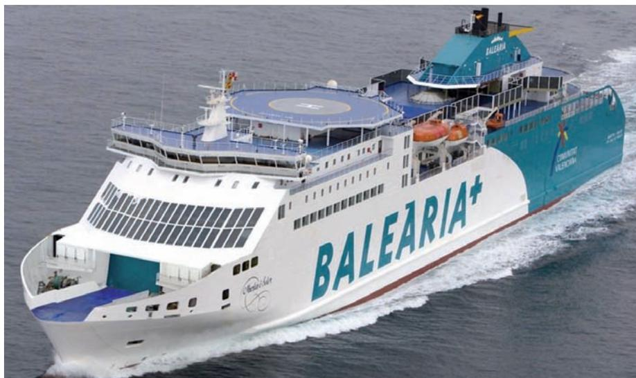
➤ Con la remotorización del “Martín i Soler”, Baleària contaba a finales de junio de 2021 con ocho de los nueve buques previstos en su plan de flota a gas. En los trabajos, los motores anteriores Mak 9M 43C del buque fueron sustituidos por el modelo Mak 9M 46DF, que además de funcionar con GNL pueden utilizar diésel. En los próximos meses concluirá el retrofit del “Hedy Lamarr”.
