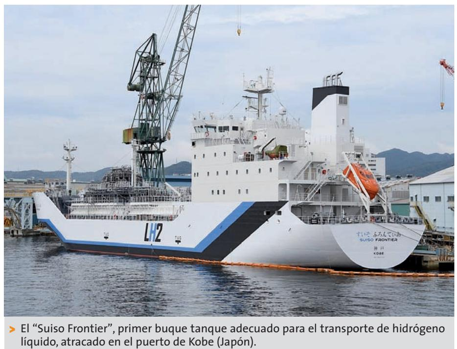
➤ El "Suiso Frontier", primer buque tanque adecuado para el transporte de hidrógeno líquido, atracado en el puerto de Kobe (Japón).
