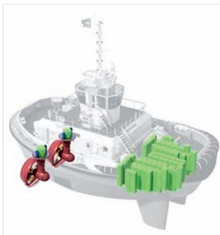
➤ El corazón del RSD – E 2513 de Damen, con los azimutales eléctricos y el montaje de las baterías.
