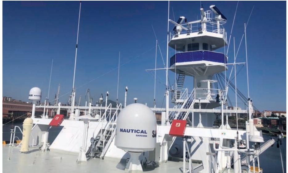
> Antenas y equipos de comunicaciones y navegación en cubierta.
