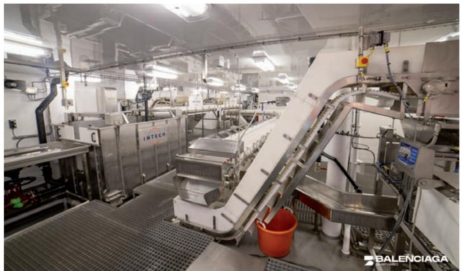
➤ Aspecto de la amplia zona bajo cubierta destinada al procesado y clasificación de las capturas, equipada con maquinaria y cintas transportadoras de Intech International (Brønderslev), firma danesa especializada en sistemas de procesado de pescado.
