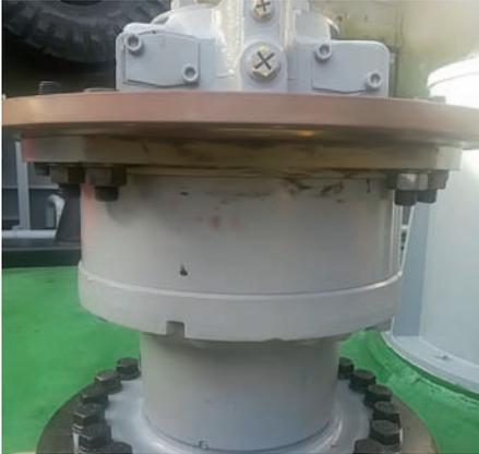
> Motor hidráulico de chigre de remolque.
