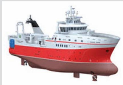
> La serie SP 336 de la ingeniería noruega Skipsteknik, a la que pertenece el “Tarajoq”. Se aprecian la hélice azimutal retráctil en proa y los estabilizadores.
