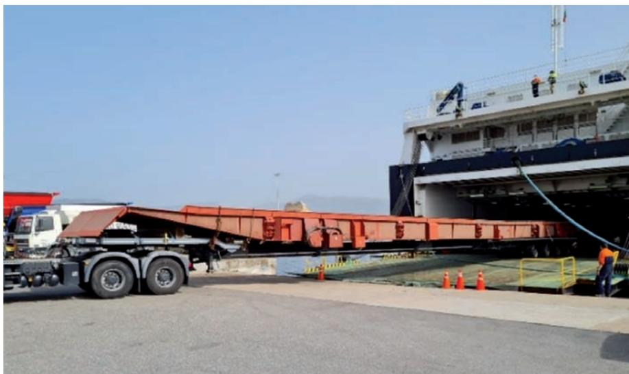
➤ Embarque mediante medios de la empresa Gesgrob de la nueva rampa suministrada por SP para enlazar la Cubierta Principal y la Cubierta Superior.
