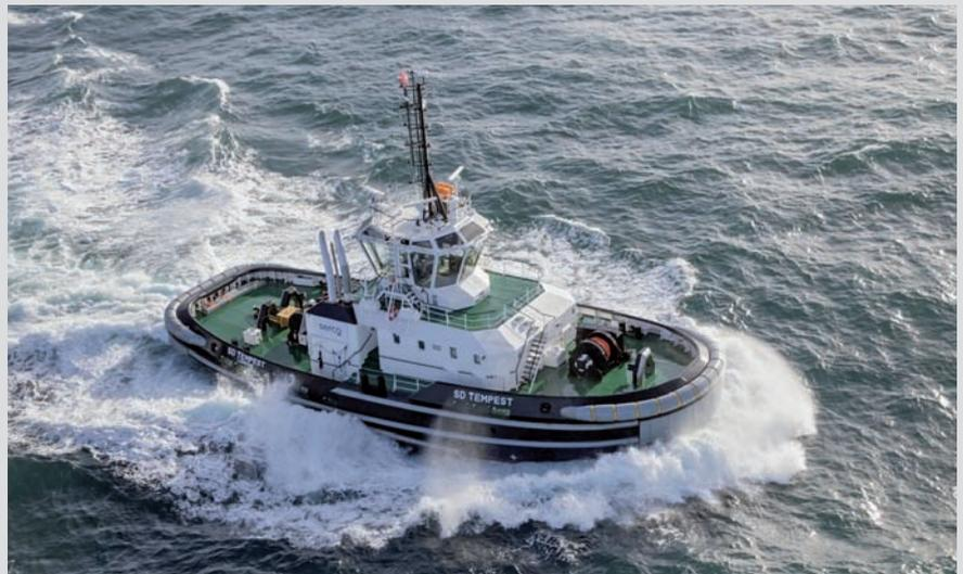
Otro de los modelos que Damen Shipyards Hardinxveld (Holanda) ofrece incorpora la configuración de propulsión patentada Advanced Rotortug (ART), compuesta por tres hélices azimutales diésel, dos de las unidades están en la proa y la tercera en la popa.
