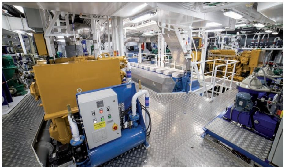
➤ La planta eléctrica del buque está integrada por generadores de CAT, acompañados por unidades auxiliares y de emergencia Caterpillar.
